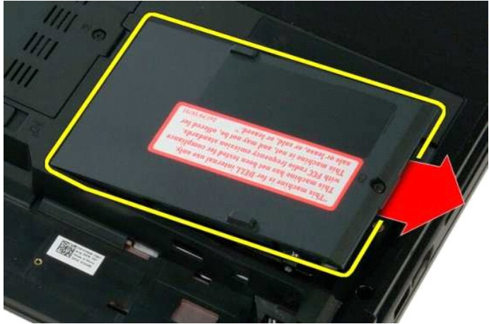
6. حرك محرك القرص الصلب داخل الجانب الأيمن من الكمبيوتر لفصل محرك القرص الصلب من الموصل الخاص به.
