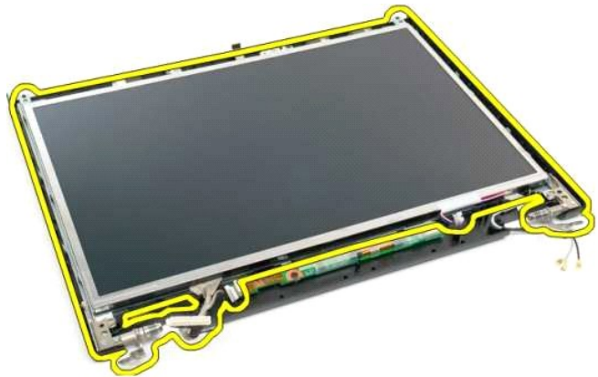
7. قم بإزالة لوحة شاشة LCD من مجموعة الشاشة.
