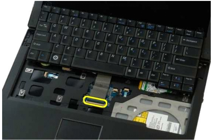
7. قم بإزالة كابل بيانات لوحة المفاتيح من المشبك.
