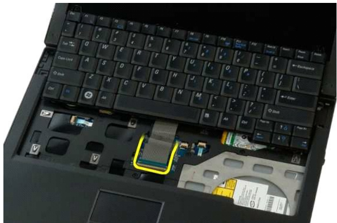
8. قم بإزالة لوحة المفاتيح من الكمبيوتر.
