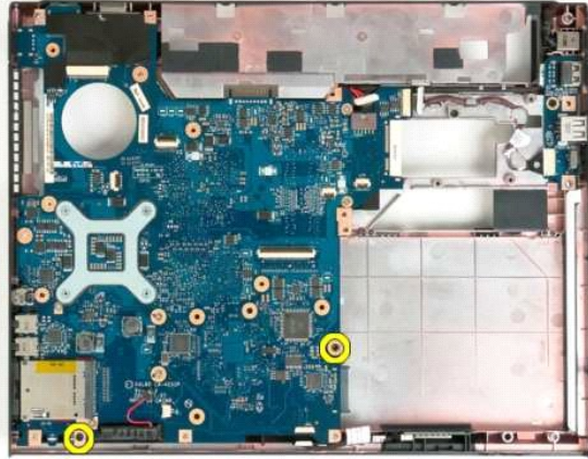
22. قم بإزالة لوحة النظام من هيكل الكمبيوتر.
