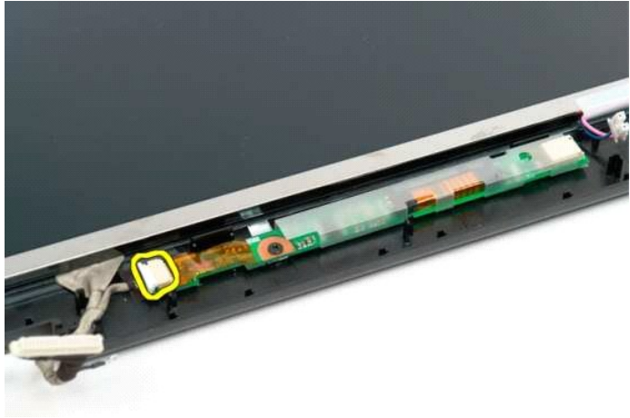
7. قم بإزالة لوحة شاشة LCD من مجموعة الشاشة.
