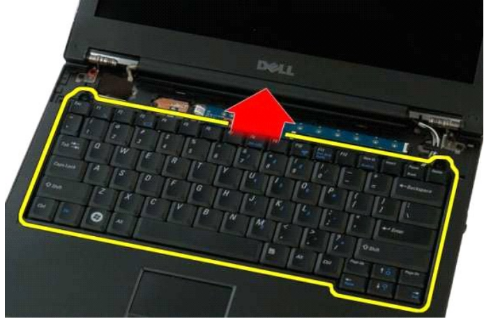
6. افتح مسبك كابل بيانات لوحة المفاتيح لتحرير كابل الشريط.
