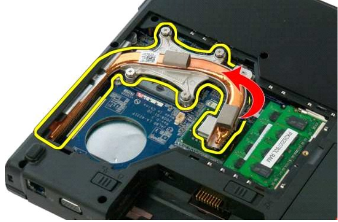
7. حرك وحدة امتصاص الحرارة تجاه وسط الكمبيوتر، ثم ارفعها ومن ثم قم بإزالتها من الكمبيوتر.
